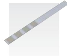
Teststreifen für Wasserhärte
